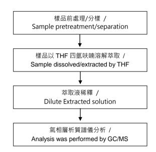
【測試方法/Test method: IEC 62321-8】
